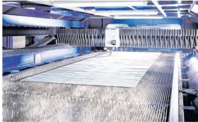
Neben dem Weben der Air-Bag-Stoffe sind bei den UTT-Kunden immer mehr perfekt zugeschnittene Teile gewünscht, was mit modernsten Laser-Schneidanlagen geschieht.
