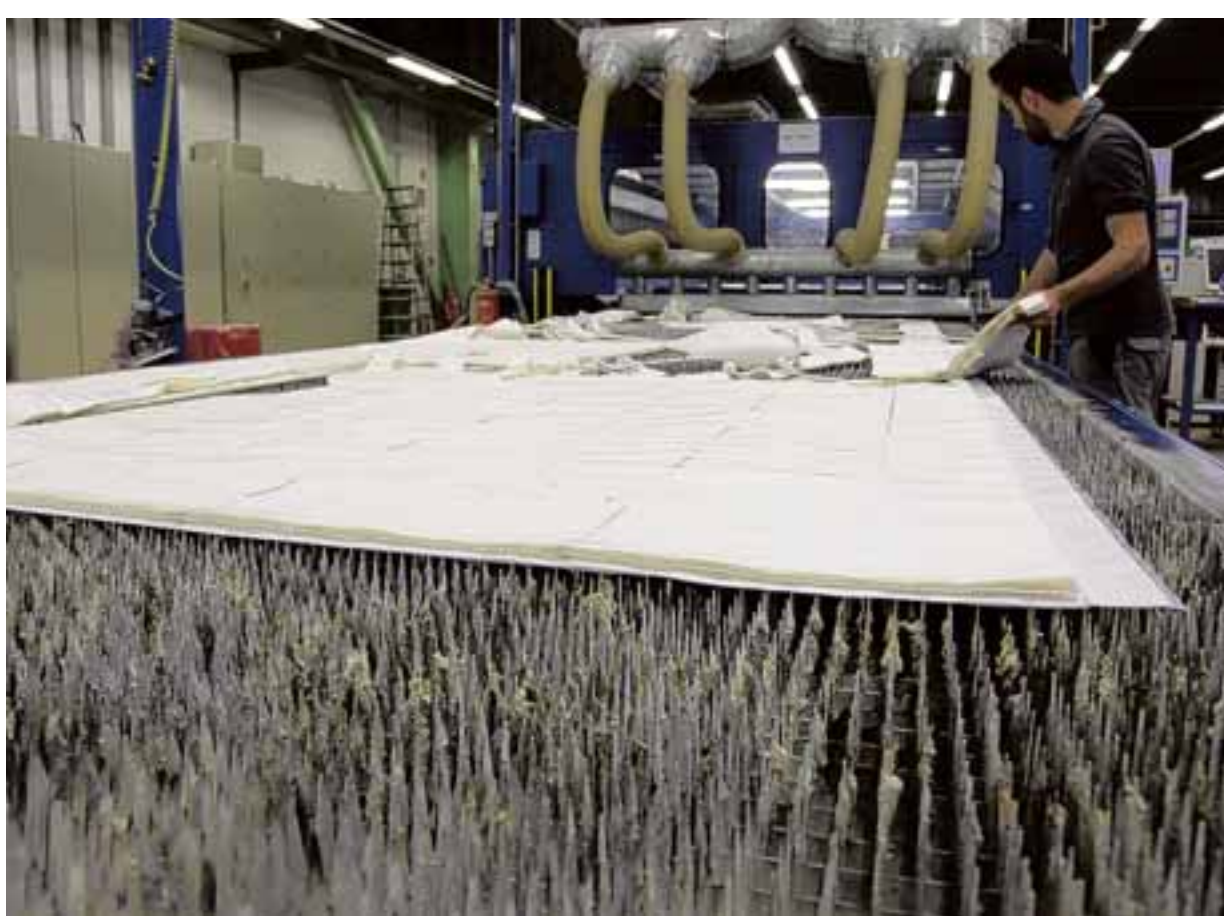
Wie ein Fakirteppich: Auf einem Spezialschlitten liegen mehrere Bahnen mit Gewebe. Eine Lasermaschine (im Bild ein älteres Modell bei UTT) schneidet daraus die Stücke für spätere Airbags.
